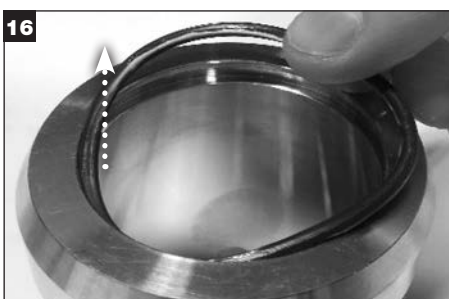
Z pouzdra vyjměte a zlikvidujte O-kroužek hřídele (V).
