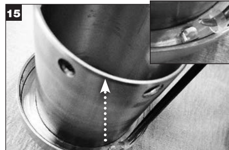
Vyjměte a zlikvidujte řídicí hadičku z přichytek pohonu v pouzdře.
